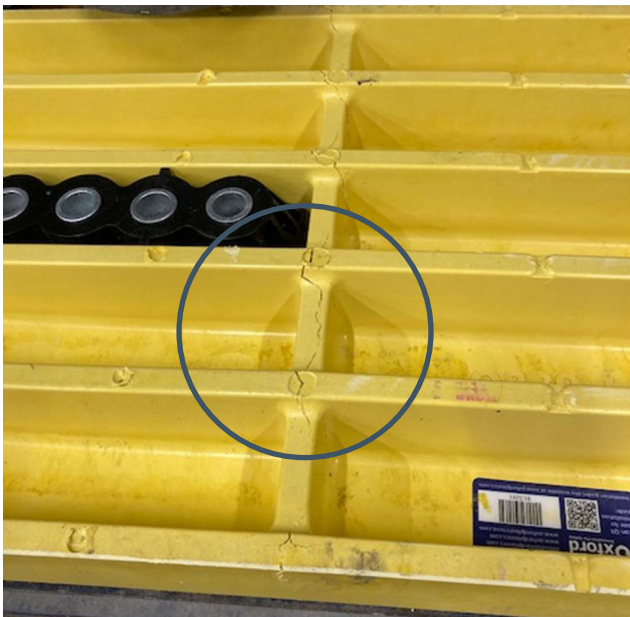
Riss entlang einer Querverstrebung
